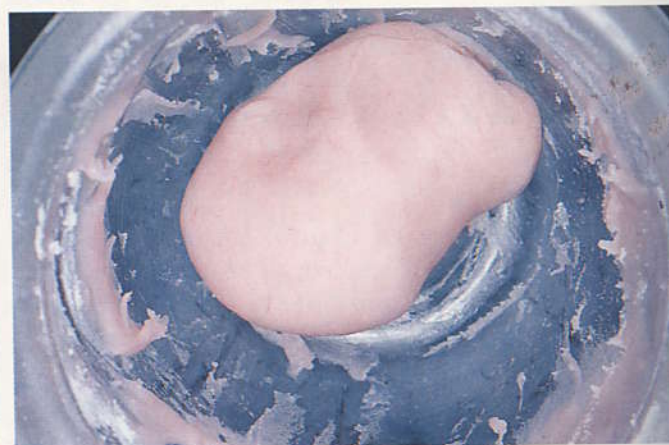
Fig. 4) Muffola Ivoclar-parte dello stampo con particolare del canale d'alimentazione.
